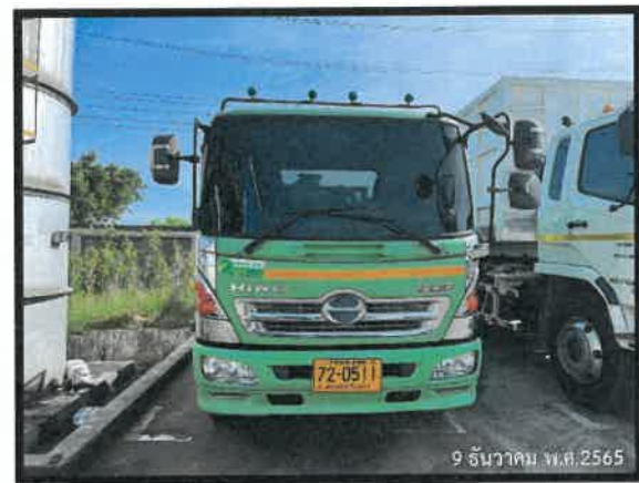
รูปที่ 3.1-20 รถบรรทุกขนส่งของเสียอันตรายติดตั้งระบบติดตามตรวจสอบการขนส่งด้วยระบบจีพีเอส (GPS)
