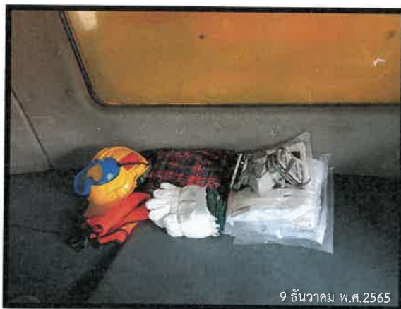
รูปที่ 3.1-16 ชุดอุปกรณ์ควบคุมการรั่วไหลของเสียในรถบรรทุก
