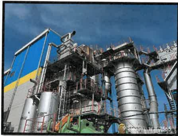
รูปที่ 3.1-5 รูปควบคุมอากาศเสียในอาคารเผาไหม้ ได้แก่ Cyclone Cooling Tower และ Bag Filter
