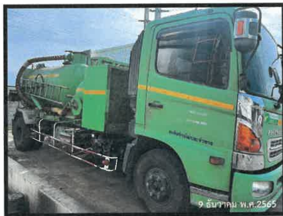
รูปที่ 3.1-20 รถบรรทุกขนส่งของเสียอันตรายติดตั้งระบบติดตามตรวจสอบการขนส่งด้วยระบบจีพีเอส (GPS)
